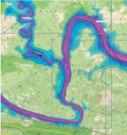
Emprise de l'onde de rupture du barrage de Nam Theun - Laos
