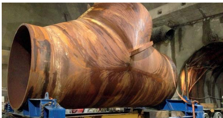
Collecteur de conduite forcée (centrale de pompage-turbinage Hongrin-Léman), Suisse
